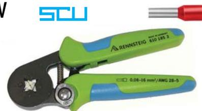
Tipo a regolazione automatica delle ganasce di serraggio. In acciaio speciale, parti operanti temprate e rettificate. Impugnature ergonomiche in materiale bicomponente. Con dispositivo di sbloccaggio in caso di cablaggi difettosi. Per cablaggi a sezione quadra e inserimento laterale del terminale a bussola.
