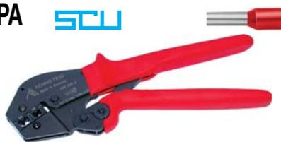
Tipo ad apertura automatica a fine bloccaggio. In acciaio speciale, parti operanti temprate e rettificate. Impugnature rivestite in materiale sintetico. Regolazione della pressione di chiusura. Con dispositivo di sbloccaggio in caso di cablaggi difettosi.
