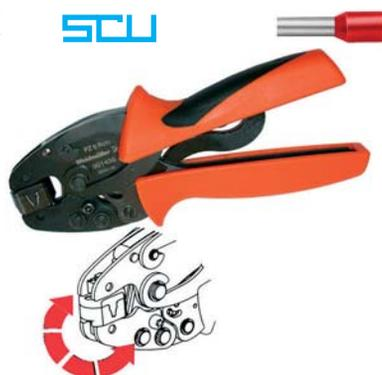
Tipo ad apertura automatica a fine bloccaggio. In acciaio speciale, parti operanti temprate e rettificate. Impugnature rivestite in materiale bicomponente. Con dispositivo di sbloccaggio in caso di cablaggi difettosi. Ganasce ruotabili per l'inserimento LATERALE O FRONTALE di terminali.
