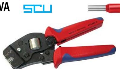
Tipo a regolazione automatica delle ganasce di serraggio. Regolazione manuale della pressione di serraggio. In acciaio speciale, parti operanti temprate e rettificate. Impugnature ergonomiche in materiale bicomponente. Con dispositivo di sbloccaggio in caso di cablaggi difettosi. Per cablaggi a sezione quadra e inserimento frontale del terminale a bussola.
