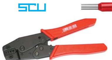
Tipo ad apertura automatica a fine bloccaggio. In acciaio speciale, parti operanti temprate e rettificate. Impugnature rivestite in materiale sintetico. Con dispositivo di sbloccaggio in caso di cablaggi difettosi.
