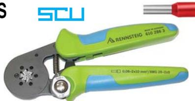
Tipo a regolazione automatica delle ganasce di serraggio. Regolazione manuale della pressione di serraggio. In acciaio speciale, parti operanti temprate e rettificate. Impugnature ergonomiche in materiale bicomponente. Con dispositivo di sbloccaggio in caso di cablaggi difettosi. Per cablaggi a sezione esagonale e inserimento laterale del terminale a bussola.
